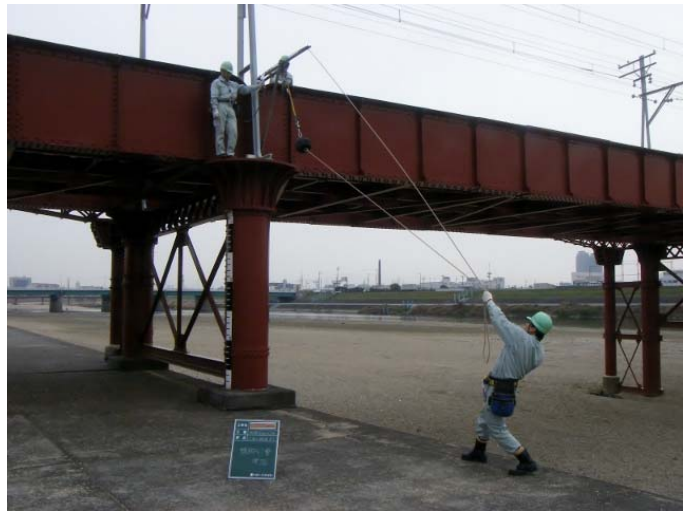
← ↓ 衝撃振動試験実施状況
