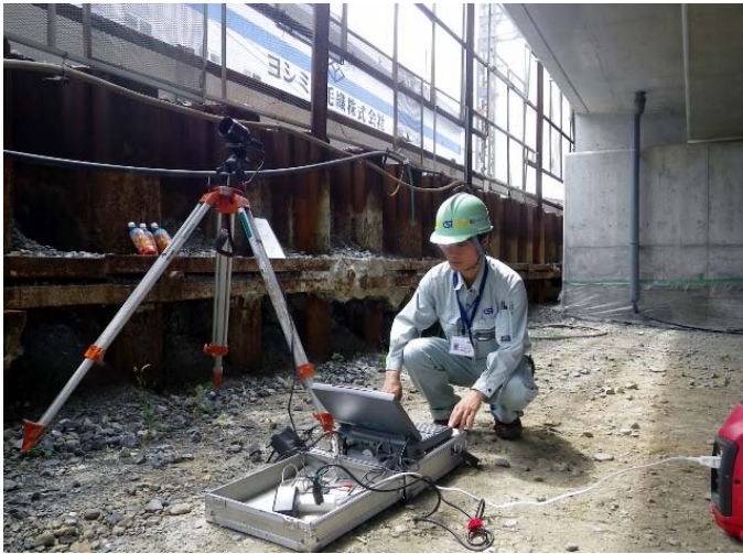
↓ 桁たわみ測定状況
