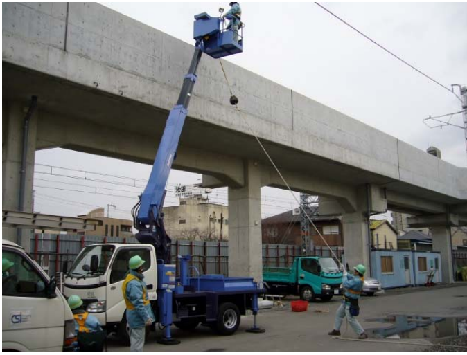
↓ 桁たわみ測定状況
